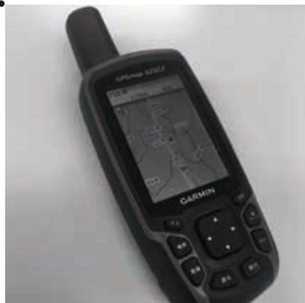
**携帯型GPS** カーナビと同じように、衛星の電波によって野外で自分の位置を確認できます。動物の目撃地点を記録したり、設置した罠の位置を記録したり、調査の必需品となっています。(村上)
