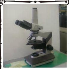
偏光顕微鏡 鉱物に光が通るように岩石を 薄く(0.03mm)し、上下に2枚の偏光板を通 して観察します。光は鉱物の結晶構造を通 ると屈折しますので、その光学性を利用し て鉱物の種類や、熟練すると化学組成も分 かります。X線によるピンポイント分析は詳 細なデータを提供してくれる反面「木を見て 森を見ず」と言われることがあります。その 点、顕微鏡では全体像が見えてきます。発 想が良ければトップレベルの研究が博物館
