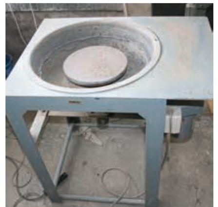
**岩石研磨機** 岩石薄片を作る機械です。中央の丸い板は下にあるモーターで回転し、その上に水に濡らした研磨材を置き、岩石を削ります。研究用機材としてだけでなく、博物館の石磨き講座でも使われています。(合地)
