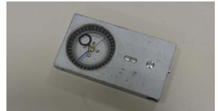
**クリノメーター** 野外で地層の水平方向と傾きを測る道具です。水平方向と傾きが分かると、どの地域に層が分布しているかが推察されます。新しい時代の堆積層を研究する場合には非常に役に立ちます。(合地)
